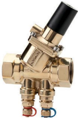
Frese PV Compact es una válvula automática de control de la presión diferencial que asegura que la presión diferencial en la unidad terminal o en el circuito sea constante.
