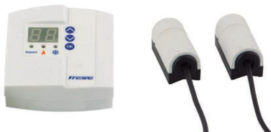
El regulador Frese OPTIMIZER 2P ha sido diseñado para utilizarse junto con la válvula Frese OPTIMA Compact y de esta manera regular el caudal requerido, tanto para calefacción como refrigeración, en instalaciones de climatización a 2 tubos utilizando una sola señal de control proporcional (0...10 VCC) desde el BMS.
