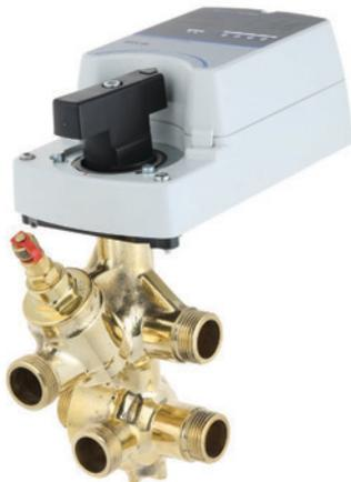
Frese COMBIFLOW es una válvula de control independiente de la presión diferencial de 6 vías, que garantiza el equilibrio hidráulico dinámico y el control, en instalaciones a 4 tubos de calefacción y refrigeración.
