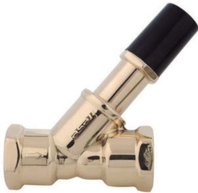
Frese DPRV es una válvula reguladora de presión diferencial ajustable, cuya función es garantizar que la presión diferencial a través del circuito no se exceda, y mantener un caudal mínimo a través del circuito, cuando las válvulas de control se van cerrando.
