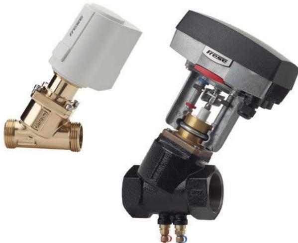
OPTIMA Compact es una válvula automática de control de caudal, presión y temperatura para sistemas de calefacción y refrigeración que combina las funciones de una de una válvula de equilibrado dinámico ajustable externamente, una válvula reguladora de presión diferencial y una válvula de control con plena autoridad, en un cuerpo de válvula único y compacto.
