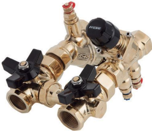
El Frese MODULA es un conjunto compacto y versátil que combina la familia de válvulas de equilibrado dinámico de Frese con: válvulas de corte con tomas de presión y temperatura, válvulas de vaciado y drenaje y otros componentes con elementos de medición y comprobación para que sólo sea necesario conectarlo a la unidad terminal. El kit permite de forma rápida y segura realizar el aislamiento, así como procesos de mantenimiento y limpieza de las unidades terminales.
