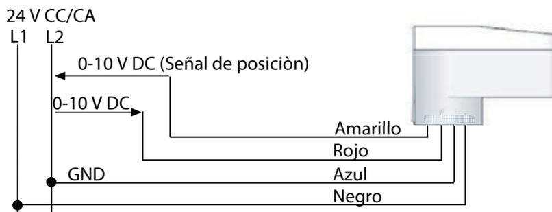
Datos técnicos- actuadores con señal de posición tipo FRS
