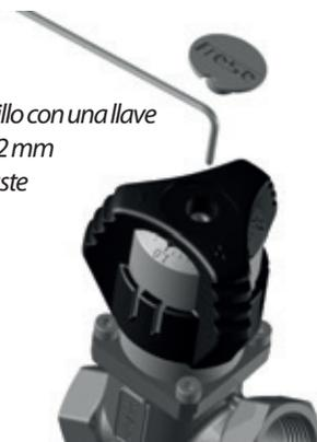
Apertar el tornillo con una llave hexagonal de 2mm para fijar el ajuste de caudal.
