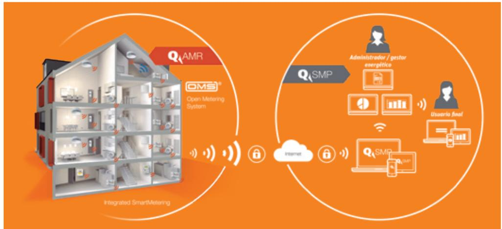
Cada uno de los equipos, recoge y almacena sus datos y los envía de forma inalámbrica al nodo de red. Los nodos de red son los encargados de transmitir los distintos consumos a la puerta de enlace, Q gateway 5 o Q gateway 5.5 direct y es ésta, quién transmite toda la información de la instalación automáticamente y vía telefonía móvil a la plataforma de medición inteligente Qundis, Q SMP (QUNDIS smart metering platform).
