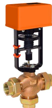
Válvula de dos vías de hierro fundido rojo RB.-BK con actuador MD100-RE para agua hasta 120°C, 16 bar
