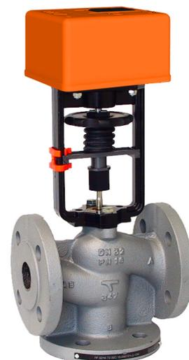
Válvula de dos vías de hierro fundido gris RF..-BF con actuador MD100-RE para agua hasta 120°C, 16 bar
