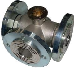
Posee una esfera perforada en T que permite el paso recto del caudal entre B y C, o bien el desvío del caudal entrante por una de las vías laterales B o C hacia la vía central A.
