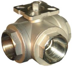
Las válvulas de 3 vías, fabricadas en acero inoxidable AISI 316, disponen de un obturador de esfera que está perforado según la hidráulica que resuelven y son accionadas por un servomotor eléctrico de rotación bidireccional. El servomotor se acopla sobre el cuerpo de la válvula con una conexión tipo ISO 5211.
