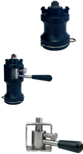
Distanciador para válvulas de 2 y 3 vías con conexión ISO 5211 que permite la instalación del servomotor a cierta distancia del cuerpo de la válvula, evitando así el peligro de condensaciones en instalaciones de climatización y en las instalaciones solares, permite aislar el servomotor de las altas temperaturas de las tuberías, prolongando su vida útil.
