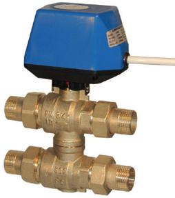
Válvulas de 4 vías con un obturador de esfera perforado para crear un by-pass entre la impulsión y el retorno. Se motorizan con un servomotor eléctrico, que se acopla al cuerpo de válvula mediante un sencillo sistema de montaje rápido.
