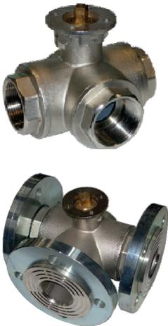
Posee una esfera perforada en L que permite el desvío del caudal de la vía A central a las laterales B y C **aislando hidráulicamente ambos circuitos**. El servomotor se acopla sobre el cuerpo de válvula con una conexión tipo ISO 5211 existiendo versiones para el control a 2 o 3 puntos, con contacto auxiliar incorporado. La elección de la posición de apertura se realiza gracias a la indicación, sobre el eje de la válvula, de la posición de las vías.
