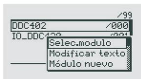
A continuación puede abrir el nivel de trabajo del sistema pulsando la tecla **[Select]**. Se muestra el nivel de trabajo del sistema.
