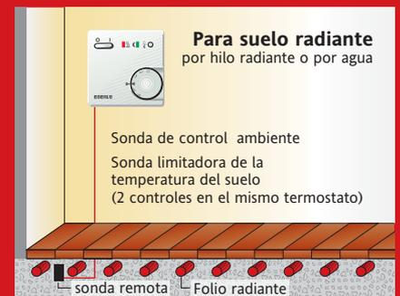
Para el control de la temperatura ambiente y la limitación de la temperatura del suelo a un valor máximo ajustado (con sonda remota) en instalaciones de calefacción por hilo radiante eléctrico o de suelo radiante por agua.
