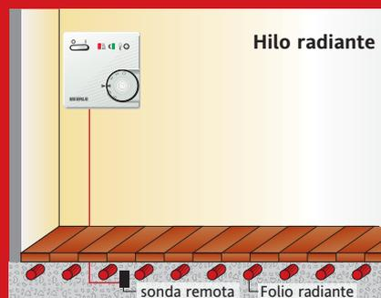
Para el control de la temperatura del suelo en instalaciones de calefacción de suelo radiante eléctrico, por ejemplo en baños (con sonda remota). Para el control y la limitación una calefacción remota.
