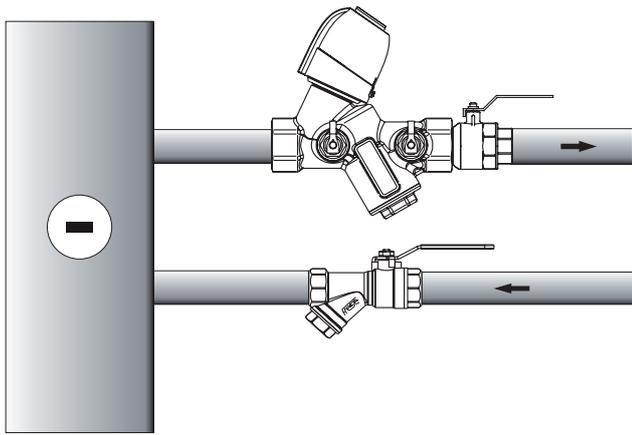
En la figura se muestra un filtro con llave de corte instalado en la impulsión en combinación con una válvula Frese Eva (válvula de zona y equilibrado dinámico de dos vías) colocada en el retorno de un fan-coil.
