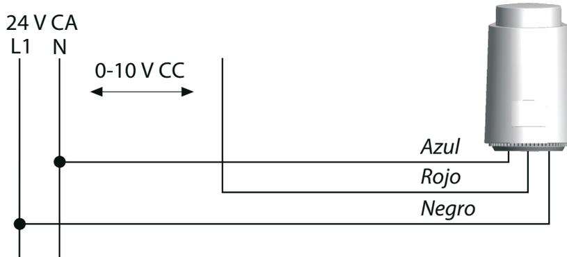
Esquemas de conexión de los actuadores electromecánicos
