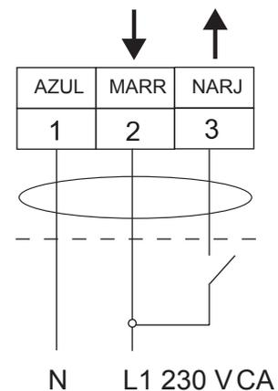
\* El actuador a 3 puntos puede utilizarse con válvulas OPTIMA Compact de carrera 2'5, 5 y 5'5 mm. El regulador que controle el actuador a 3 puntos debe configurarse de acuerdo a la carrera de la válvula, teniendo en cuenta que el tiempo de apertura del actuador es de 13 s/mm.
