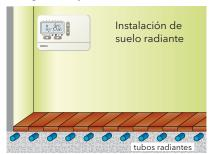
Para el control de la temperatura ambiente en sistemas de calefacción por suelo radiante
