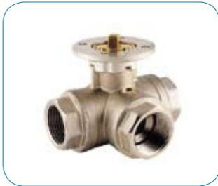
Posee una esfera perforada en L que permite el desvío del caudal de la vía A central a las laterales B y C **aislando hidráulicamente ambos circuitos (ver Fig.1 y Fig.2)**. El servomotor se acopla sobre el cuerpo de válvula con una conexión tipo ISO 5211 existiendo versiones para el control sobre la válvula a 2 o 3 puntos, con contacto auxiliar incorporado. La elección de la posición de apertura se realiza gracias a la indicación sobre el eje de la válvula de la posición de las vías.
