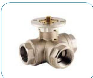
Posee una esfera perforada en T que permite el paso recto del caudal entre B y C, o bien el desvío del caudal entrante por una de las vías laterales B o C hacia la vía central A. **(Ver Fig 1- 2 y 3-4)**.
