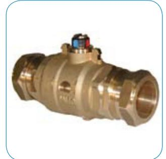
Las válvulas de 2 vías poseen un obturador de esfera con paso directo todo-nada accionado por un servomotor eléctrico de rotación unidireccional (Ver Fig.1 y Fig.2). El servomotor se acopla sobre el cuerpo de válvula mediante un sistema de montaje rápido tipo clip.
